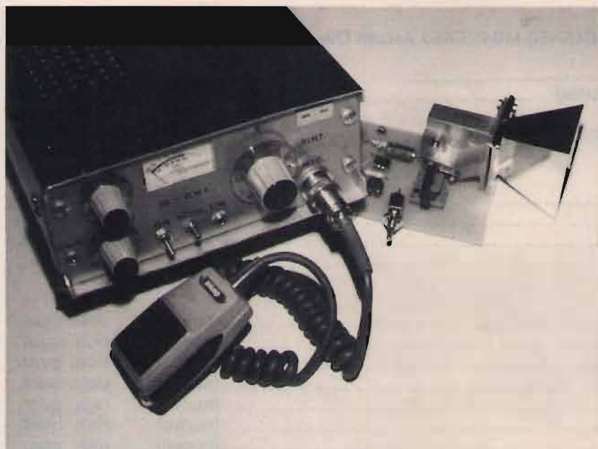
Ricetrasmittitore per 10 GHz autocostruito utilizzato con beacon.
