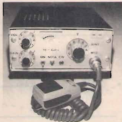
Ricetrasmittitore per i 10 GHz autocostruito.
